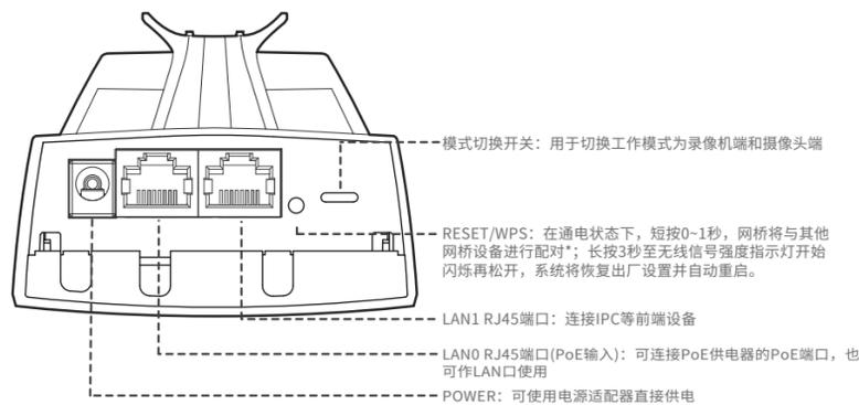
\*配对说明：需保证两个网桥设备的工作模式分别为录像机端和摄像头端。15分钟内，分别短按两个设备的RESET/WPS按键，信号指示灯将以流水灯形式闪烁，设备进入配对状态；若信号指示灯变为常亮，则配对成功，若信号指示灯整体快闪，则配对失败，需重新操作。
